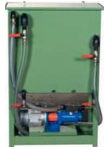
Primární komora (Gravitační usazování).
